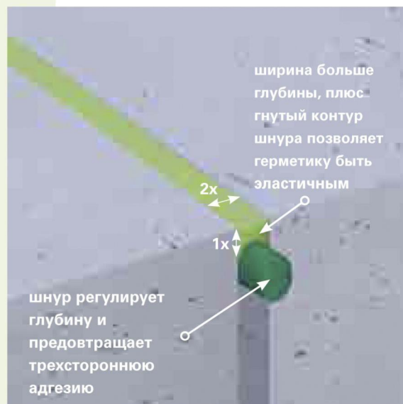
Шов в бетонном полу
